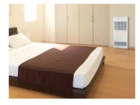
電気温水暖房システムとは、電気を熱源とする温水によるセントラルヒー ティングです。電気温水ボイラーにより暖められた温水 (不凍液)を、各部 屋、廊下等に設置した放熱機器(パネルラジエーター、パネルコンベクター、 ファンコンベクター、床暖房パネル等)へ送り、家全体をムラなくやさしく 暖めます。運転音も静かで、燃焼排ガスやニオイもないので、クリーンです。 また、操作が簡単で、火を使わないので安心感が違います。
