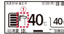
① 給湯使用中の給湯流量をイラスト(5段階)で表示します。
