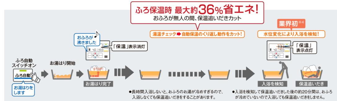
※2 (条件) 高断熱浴槽を使用。当社環境試験設備にて外気温7℃、お湯はり量180L、お湯はり温度40℃、ふろ配管架橋ポリエチレン管13A・6m、断熱材厚さ10mm。お湯はり完了後、2時間保温運転中に2人入浴を想定した場合の比較。省エネ保温1,900kJ / 従来保温2,950kJの比較。
