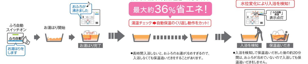
※5 (条件) 高断熱浴槽を使用。当社環境試験設備にて外気温度7℃、お湯はり量180L、お湯はり温度40℃、ふる配管架橋ポリエチレン管13A・6m、断熱材厚さ10mm。お湯はり完了後、2時間保温運転中に2人入浴を想定した場合の比較。省エネ保温1,900kJ/従来保温2,950kJの比較。
