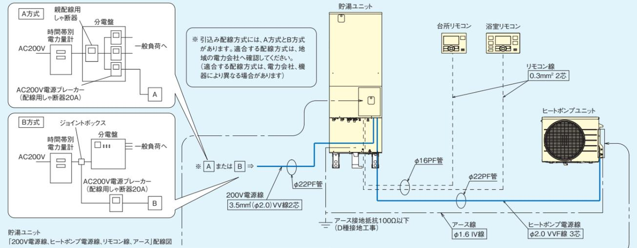
貯湯ユニット「200V電源線、ヒートポンプ電源線、リモコン線、アース」配線図
