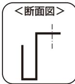
**2** 倒れ防止金具大を付属のネジ⑥でアタッチメント上に固定します。
