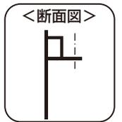
**2** 倒れ防止金具小を付属のネジ⑥でアタッチメント上に固定します。
