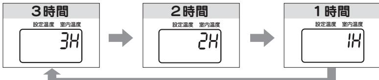
[延長セレクトキーを押している間、デジタル表示部には延長時間が表示されますが、手を放すと自動的に温度表示に切りかわります。]
