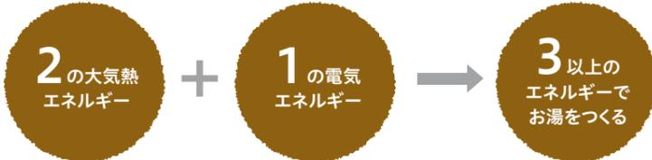
エコキュートは『1』の電気エネルギーを使って『2』の大気熱エネルギーをくみ上げることで、『3以上』の熱エネルギーを生み出します。
