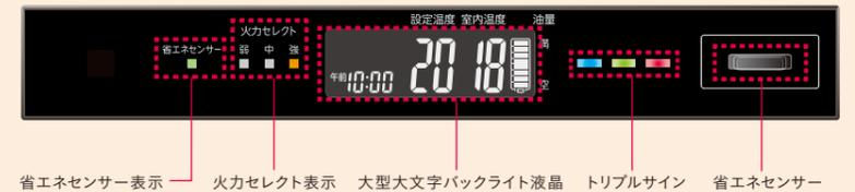
省エネセンサー表示 火力セレクト表示 大型大文字バックライト液晶 トリプルサイン 省エネセンサー
