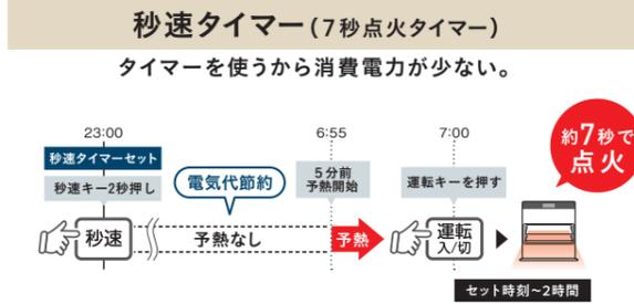
※秒速タイマーセット時刻の5分前から予熱を開始します。予熱はタイマーセット時刻より2時間持続し、平均約80Wの電力を消費します。※点火すると設定は解除されます。
