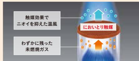
わずかに残った未燃焼ガスをにおいとり触媒(セラミック・酸化鉄触媒)により浄化します。
