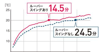
お部屋の温度をすばやく上げる**ターボモード搭載** ターボキーを押すと、定格出力**プラス10%の暖房出力**で運転開始。180秒からカウントダウンを終了するとお知らせブザーを鳴らして通常運転に戻ります。
