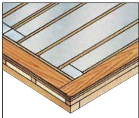
●ダミーボード施工
