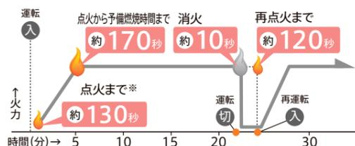
※室温、外気温によって点火時間は変動します。(消火直後の再点火は、点火までに消火回路が働いている2分間がプラスされます)
