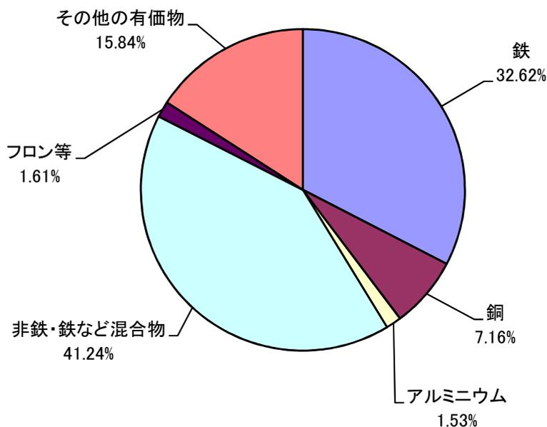
冷蔵庫・冷凍庫の材料構成比
