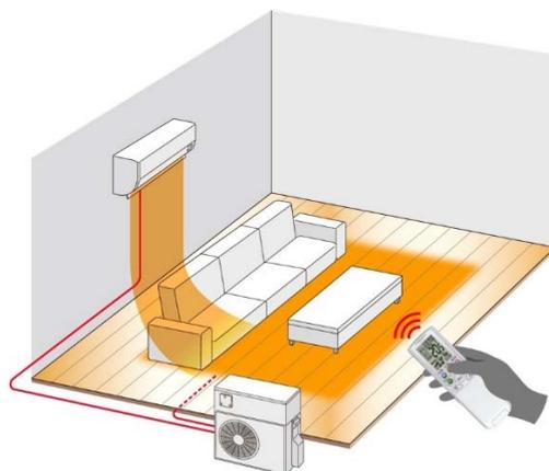
コロナエコ暖クールエアコンは、1つのヒートポンプ室外機により、夏はエアコン冷房、冬はエアコン暖房と温水床暖房を連動制御し、速暖性と快適性を両立すると共に、高い環境性と省エネ性を実現した製品です。省エネ性は、当社従来製品と比較しエアコンで20%、床暖房で4%向上しています。また、CO<sub>2</sub>排出量はガス熱源の製品に対し、43%の削減を達成しています。
