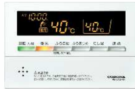
インターホン浴室リモコン
